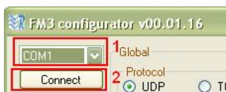
Fig. 6.3.1.1 COM port drop-box
